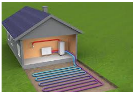
Slika 6: Delovanje TČ (horizontalni kolektor) zemlja – voda
